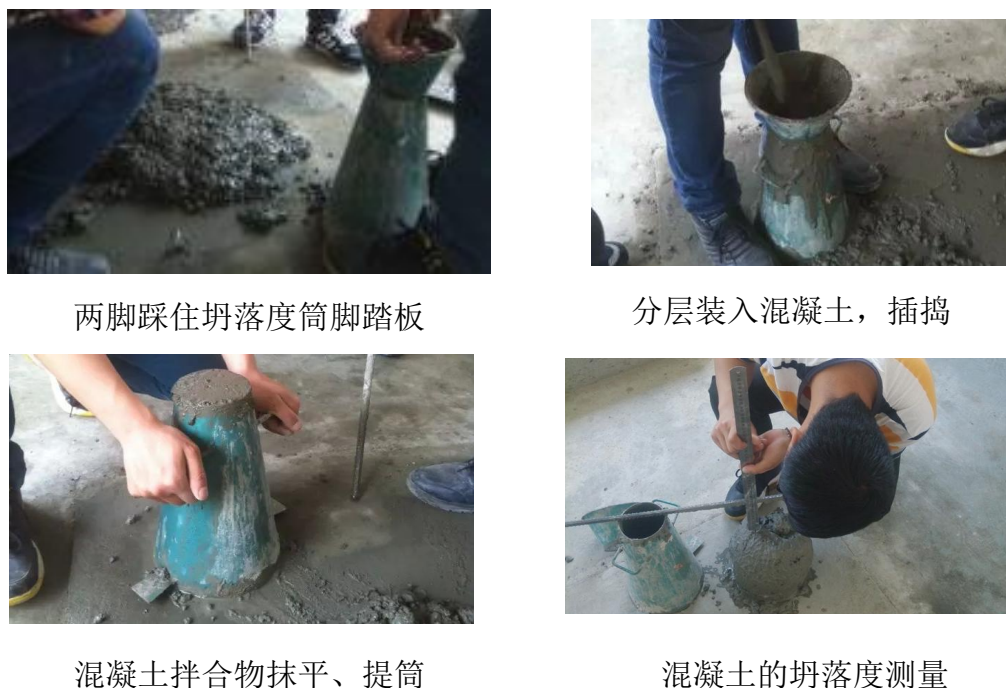
图 3-2 再生微粉混凝土坍落度试验过
