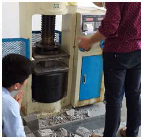
图 3-6 混凝土试块压力测试
