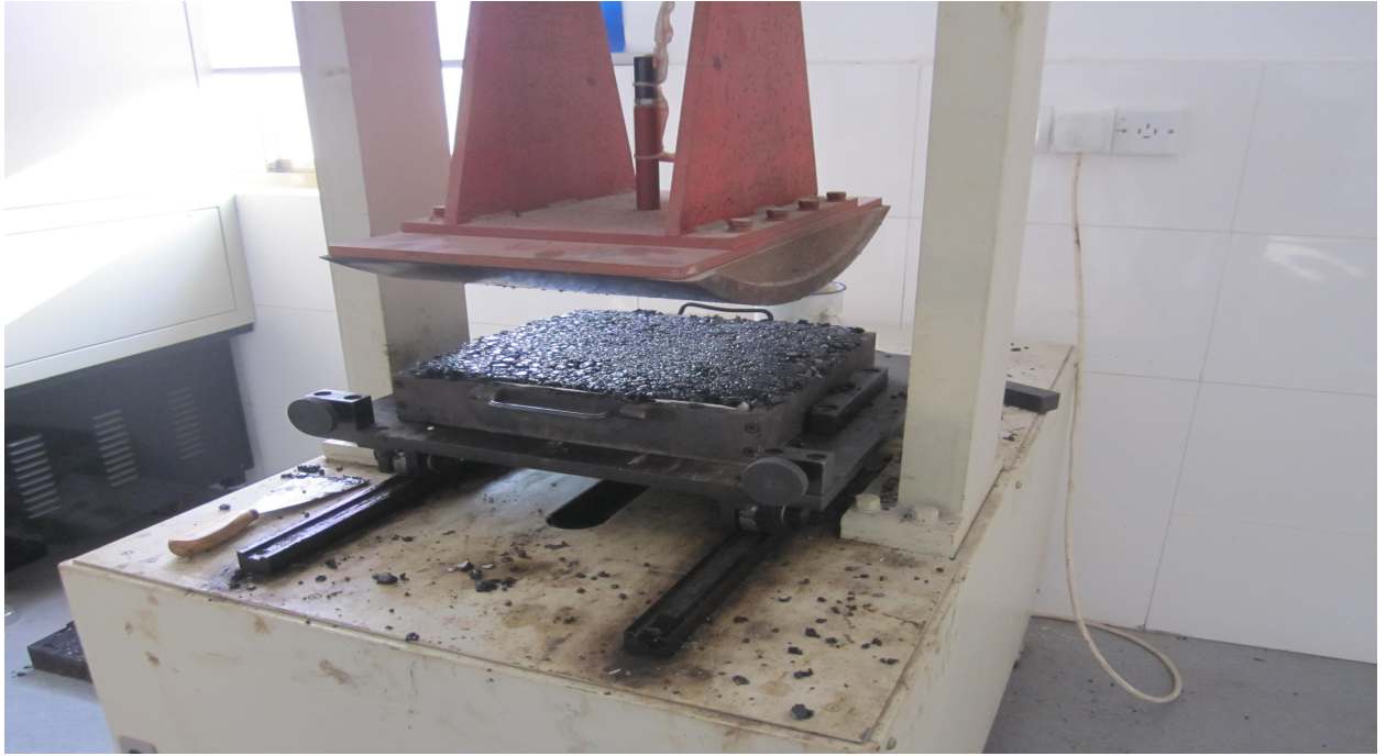
图 4.5 车辙试件成型
