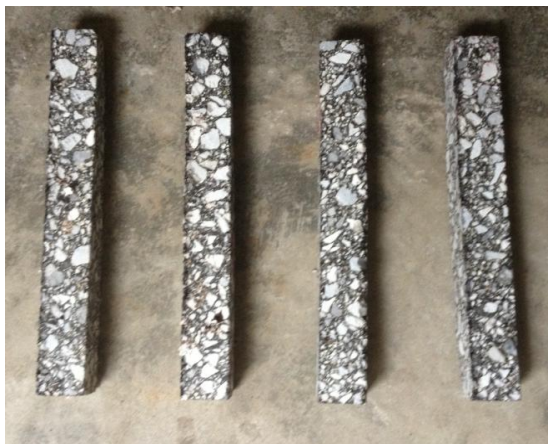
图 4.8 弯曲试验试件
